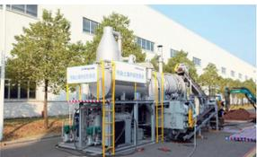
实施性。专业、细致、严谨的方案设计同样也得到了业主、监理及验收单位的高度认可。该方案由永清环保旗下子公司永清启望土壤修复科技股份有限公司（上海）有限公司（以下简称“永清启望”）组织编制，是国内少有的采用“异位热脱附+土壤淋洗”复合技术修复复杂污染场地的案例。
